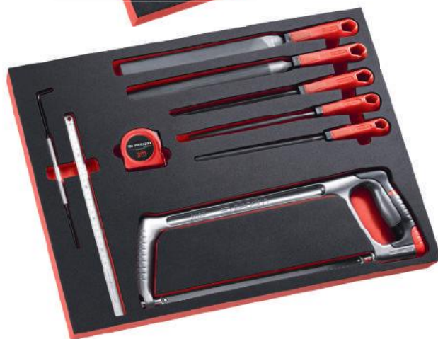
MODUŁ Z PIŁĄ, NARZĘDZIAMI POMIAROWYMI I PILNIKAMI MODM.603FPB - 603F: rama piły - 668A.10: 10 brzeszczotów (10 zębów na cm) - 234.S: rysik - DELA.1051.300M: dwustronny liniał ze stali nierdzewnej 300 mm - 893B.319: taśma miernicza 3 m - PAM.B250EMA: 5 pilników z uchwytami (płaskie pilniki równiaki) DRD.MD250EMA: półokrągły pilnik pośredni CAR.MD200EMA: kwadratowy pilnik pośredni TRI.MD200EMA: trójkątny pilnik pośredni RD.MD200EMA: okrągły pilnik pośredni - Tacka piankowa: PM.MOD603F Wymiary: 42 x 56,4 x 4,5 cm (= szerokość 3 modułów ogólnego przeznaczenia) Ciężar: 2,70 kg
