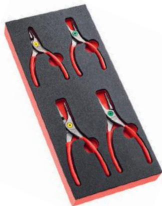
MODUŁ Z 4 SZCZYPkami CIRCLIPS® MODM.PCSN - 177A.13 (10 - 25 mm) - 177A.18 (19 - 60 mm) proste szczypce zewnętrzne - 179A.13 (12 - 25 mm) - 179A.18 (19 - 60 mm) proste szczypce wewnętrzne - Tacka piankowa: PM.MODPCSN Ciężar: 0,70 kg
