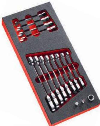
MODUŁ Z 12 PRZEGUBOWYMI GRZECHOTKOWYMI KLUCZAMI PŁASKO-OCZKOWYMI ULTRA GRIP I PRZEJŚCIÓWKAMI MODM.467BFJ12 - 467BF.: 8 - 9 - 10 - 11 - 12 - 13 - 14 - 15 16 - 17 - 18 - 19 mm - 3 przejściówki (467.ADAPT10-19): nasadki 1/4" i 1/2" - Tacka piankowa: PM.MOD467FJ12
