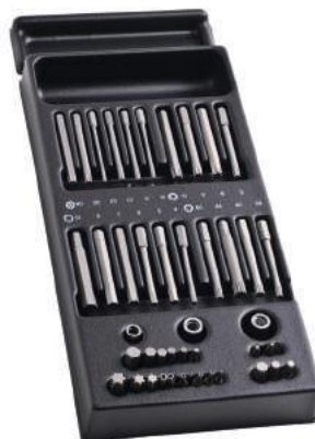
MODUŁ Z 20 KOŃCÓWKAMI DO WKREĆANIA MOD.E20L Sześciokątne: EH.2L: 4 - 5 - 6 - 7 - 10 mm XZN: EV.2L: 5 - 6 - 10 mm Torx: EX.2L: 30 - 40 - 45 - 50 Resistorx: EXR.1L: 10 - 15 - 20 - 25 - 30 - 40 SJ.236: uchwyt na końcówki CDX 5/16 R.235: uchwyt na końcówki nasadowe 1/4" S.236: uchwyt 5/16 na końcówki nasadowe 1/2" - Wkładka formowana termicznie: PL.624 Ciężar: 0,755 kg
