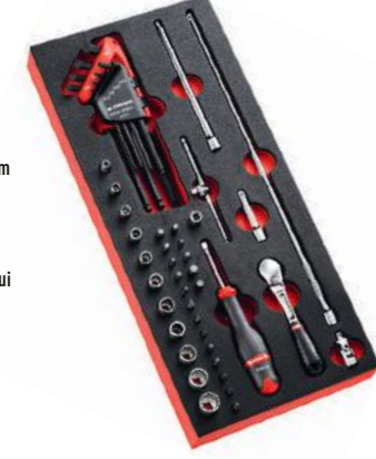
MODUŁ Z SZEŚCIOKĄTNYMI NASADKAMI 1/4" Z GRZECHOTKĄ Z BLOKADĄ W ROZMIARACH CAŁOWYCH MODM.RL2U - Nasadki: R.E 3/16 - 9/16" - R.L.161: grzechotka - R.120A: przesuwna rękojeść - J4763: przedłużenie - R.209 - R.215: 2 przedłużenia 55 - 150 mm - 83SH.JP8AU: klucz imbusowy z tłem kulistym w rozmiarze imperialnym - R.236A: rękojeść obrotowa - R.240A: przegub - R.235: uchwyt na końcówki Kończówki: Pozidriv®: 1 - 2 - 3 Phillips®: 1 - 2 - 3 Płaskie: 4,5 - 6,5 Sześciokątne: 3 - 4 - 5 - 6 - 7 mm Resistorx®: 15 - 20 - 25 - 30 - 40 - Tacka piankowa: PM.MODRL2U
