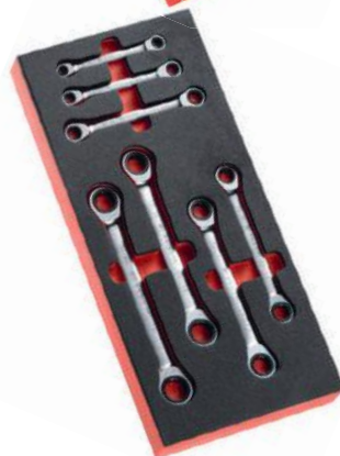
MODUŁ Z 7 PROSTYMI GRZECHOTKOWYMI KLUCZAMI OCZKOWYMI - 12-KĄTNYMI 6 - 19 MM MODM.64J7 - 64J.: 6 x 7 - 8 x 9 - 10 x 11 - 12 x 13 14 x 15 - 16 x 18 - 17 x 19 mm - Skok 5° - Tacka piankowa: PM.MOD64J7 Ciężar: 0,925 kg
