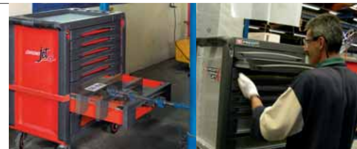
Szuflady są testowane dla 50000 cykli otwarcia/zamknięcia co oznacza 10 lat użytkowania.
