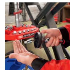
4 Spadanie kropli z korka nad pojemnikiem na olej.
